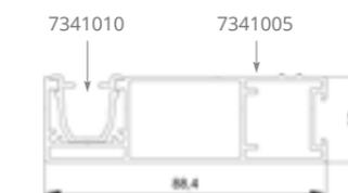
Guida singola standard per il sistema F-A.
