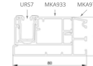
Guida singola standard per il sistema FZF-S.
